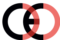
Falsk CE-mærke (for tæt på hinanden)
